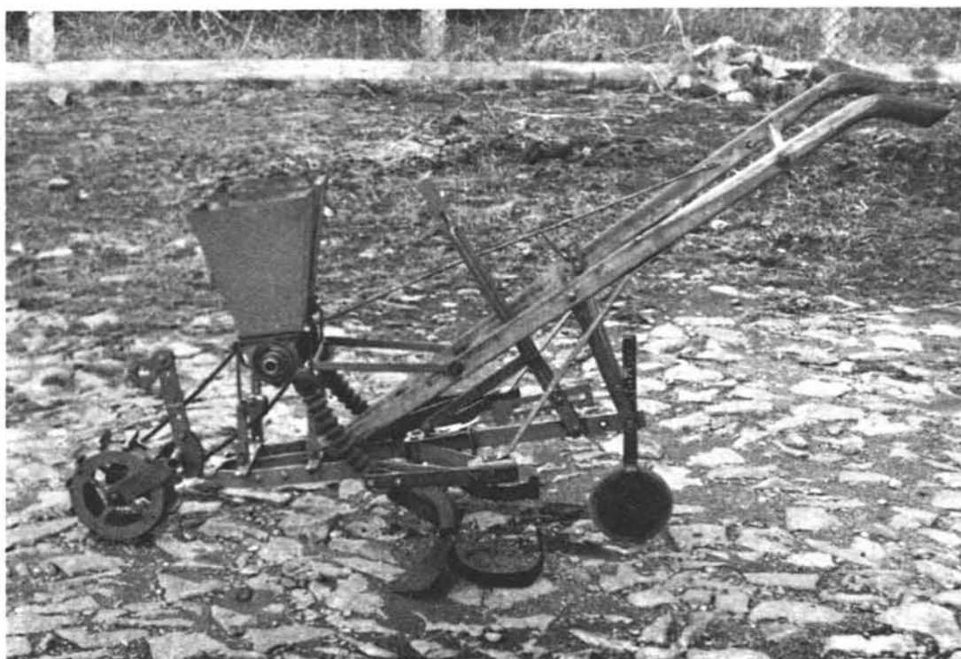
Figura 6. Semeadeira desenvolvida pelo CNPMS-EMBRAPA, que permite a semeadura simultânea de duas linhas do milho após a sua maturação fisiológica.
