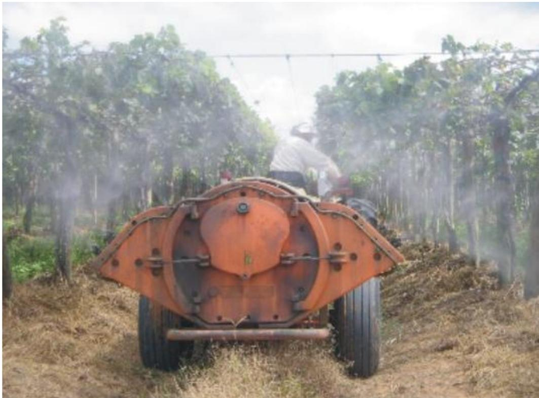
**Figura 4.** Uso de pulverizador com cortina de ar montado em reboque sobre rodado de pneus na cultura da videira
