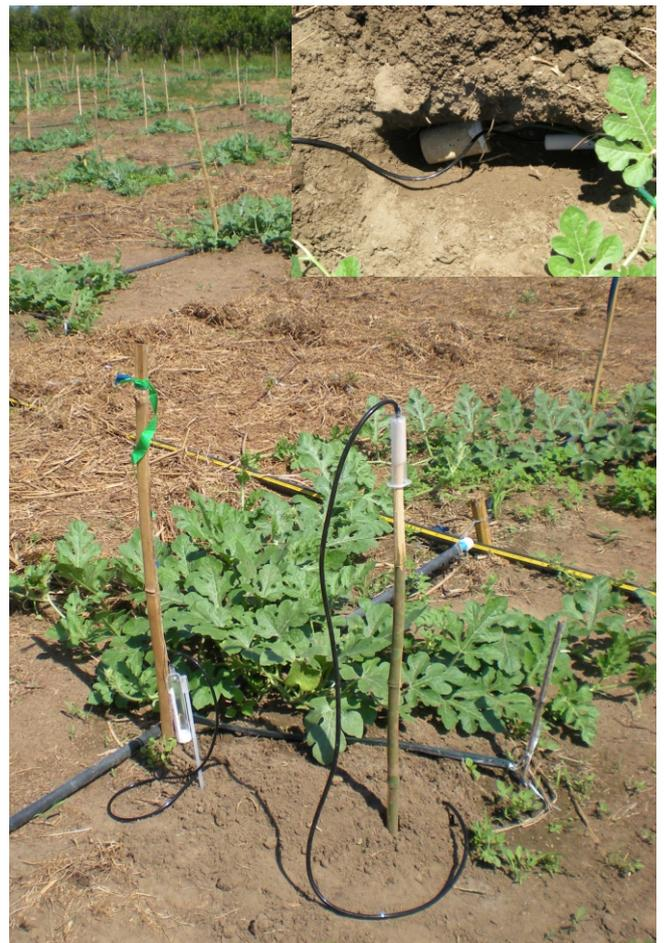
**Figura 1.** Sensor de umidade do solo Irrigas (à esquerda, variante artesanal confeccionada com vela de filtro; à direita, variante comercializada).
