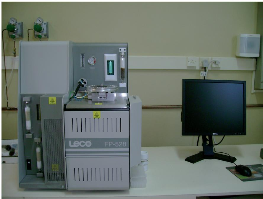
Figura 2. LECO FP-528 para análise de nitrogênio total pelo método de Dumas.
