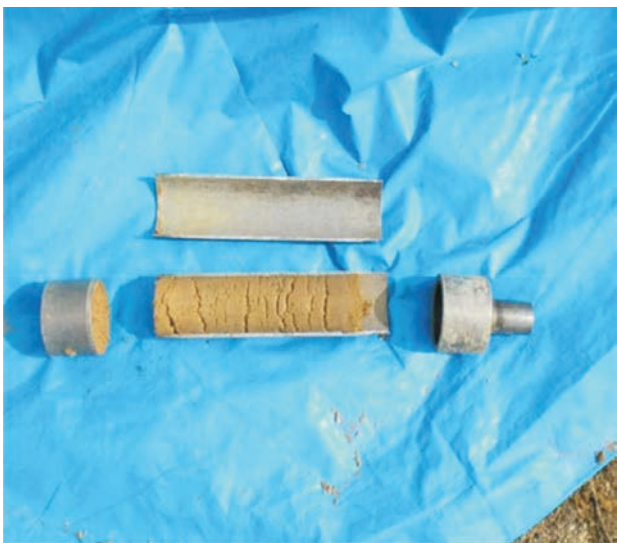
Figura 9. Coleta de amostras indeformadas obtidas com a utilização de cilindro metálico (amostrador Shelby), cravados no solo com o auxílio de uma
