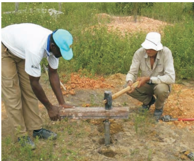
Figura 8. Coleta de amostras indeformadas obtidas com a utilização de cilindro metálico (amostrador Shelby), cravados no solo com o auxílio de uma sonda de percussão.
