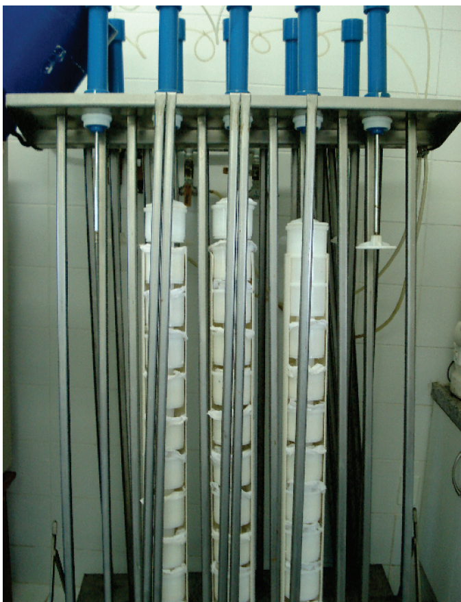
Fig. 9. Prensagem dos queijos utilizando prensa pneumática.
