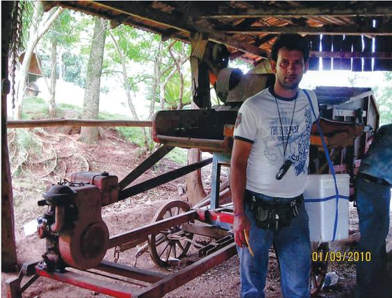
**Figura 4.** Trilhadeira usada para debulha de feijão.
