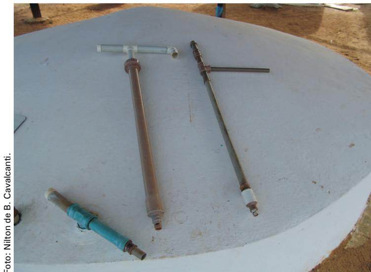
**Figura 4.** Modelos de Bombas de PVC.
