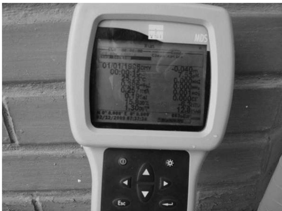
**Foto 7.3.** Terminal de leitura digital da sonda multipâmetros de medição das características físicas e químicas das águas de uso doméstico, utilizada nas pesquisas a campo.
