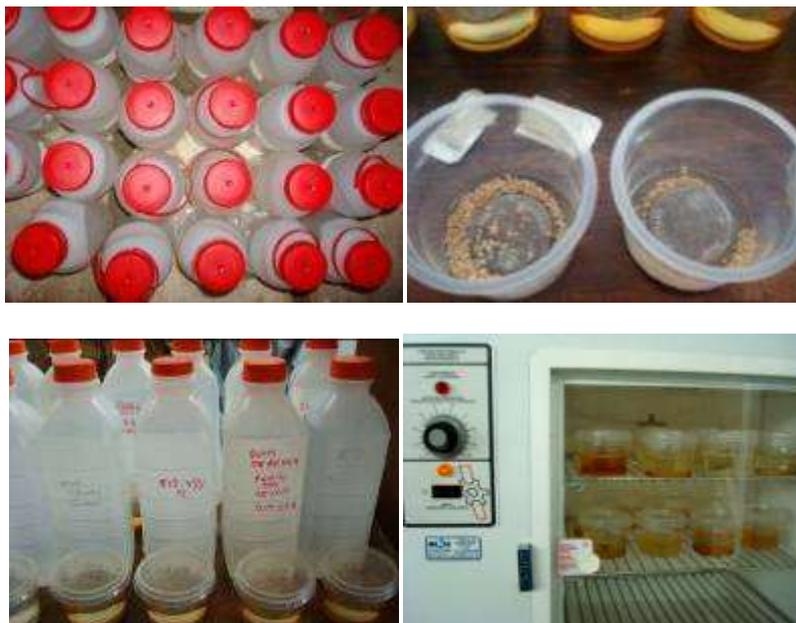
**Foto 7.2.** Amostras de água engarrafadas, Kit de meio de cultura enriquecido, preparo da amostra e armazenamento em estufa a 37° C por 24 h.
