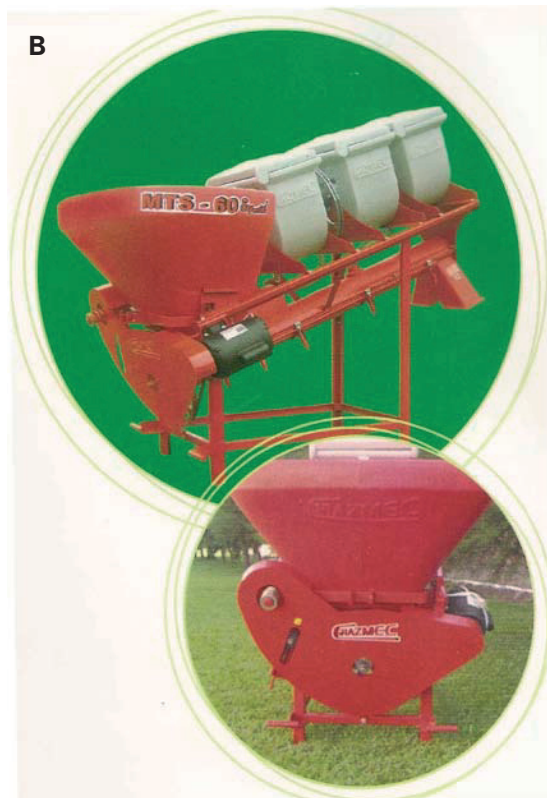
Figura 2. Máquinas de tratar sementes. (A) rendimento superior a 13 t/h e (B) capacidade de 60 sacos/h
