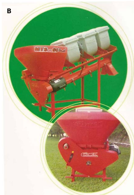
Figura 2. Máquinas de tratar sementes. (A) rendimento superior a 13 t/h e (B) capacidade de 60 sacos/h
