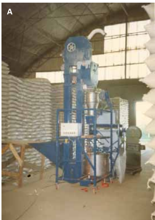
Figura 2. Máquinas de tratar sementes. (A) rendimento superior a 13 t/h e (B) capacidade de 60 sacos/h
