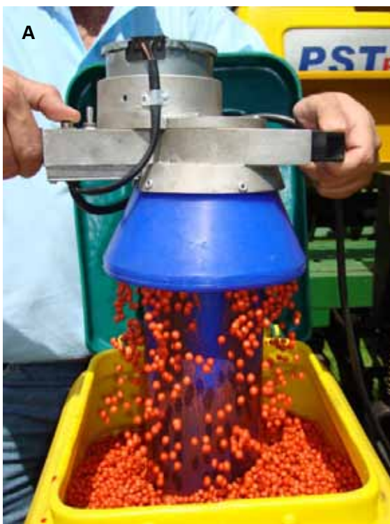
Figura 3. Máquina de tratar sementes diretamente na caixa da semeadora (A) e em outro recipiente (B).
