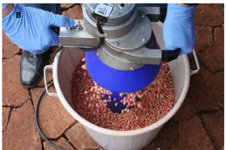
Figura 3. Máquina de tratar sementes diretamente na caixa da semeadora (A) e em outro recipiente (B).
