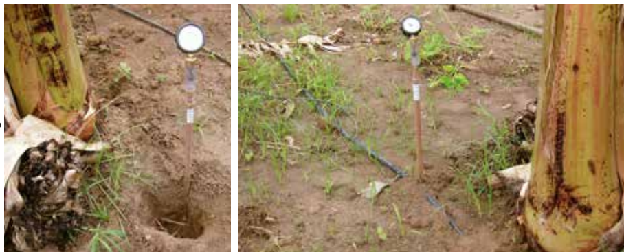
Figura 7. Posicionamento de tensiômetros na cultura da bananeira irrigada por microaspersão.
