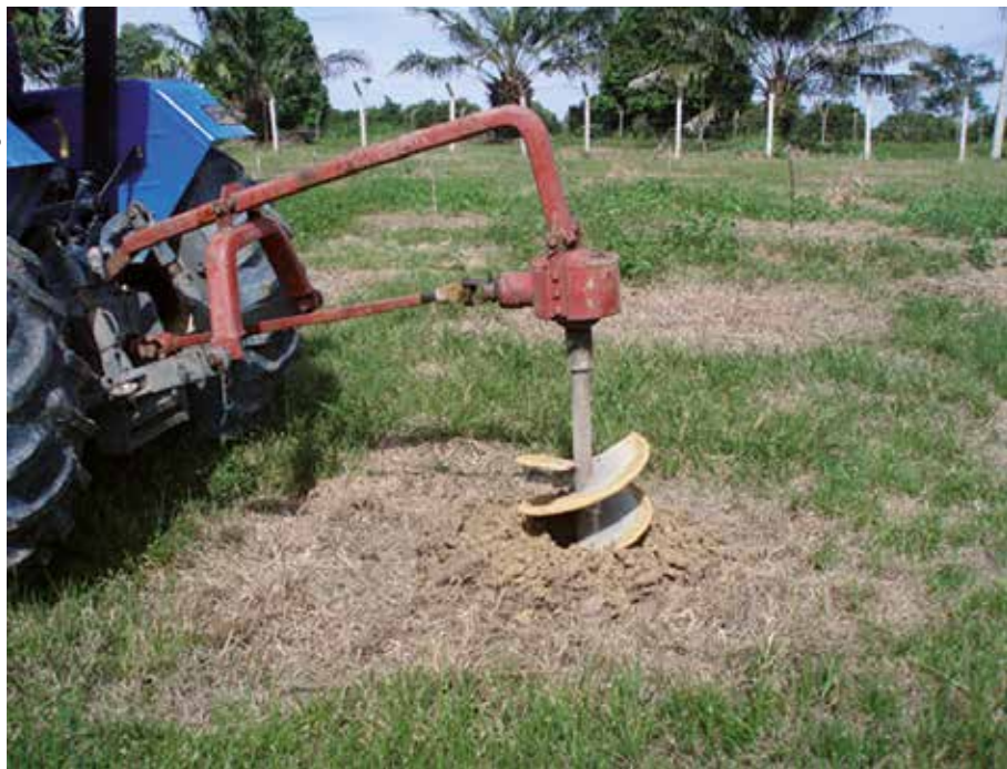
Figura 2. Abertura mecanizada de covas com broca acoplada ao trator, para o plantio de bananeira.
