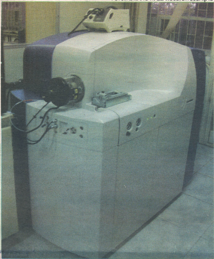
Espectrômetro de massa Q-TOF instalado no Laboratório de Cromatografia e Espectrometria de Massa da Empresa Uva e Vinho: exemplo de aparelho de última geração de que a instituição dispõe.
