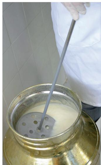
**Atenção:** Em latão, deve-se utilizar um agitador manual (agitador de latão) por, no mínimo, dez segundos. Misturar o leite das camadas superiores com o das camadas inferiores, pelo menos dez vezes, com movimentos suaves e contínuos. O movimento do agitador deve ser sempre na direção vertical (para cima e para baixo).
