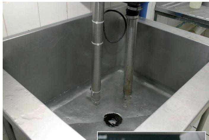
Enchimento da cuba com água morna (35 °C a 43 °C) ou água em temperatura ambiente
