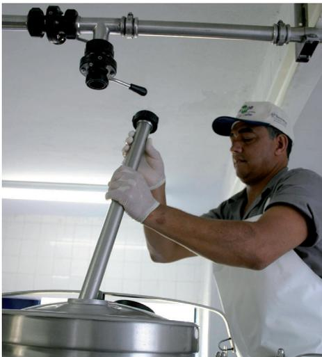
**Atenção:** Em outros tipos de ordenha que não o ilustrado, o mangote de leite deve ser retirado de dentro do tanque de refrigeração antes de iniciar a limpeza. Para a primeira etapa, a de pré-enxágue, o mangote deve ser colocado para fora da cuba de água, e, nas etapas seguintes, deve ser colocado dentro da cuba de água, para a solução poder circular.
