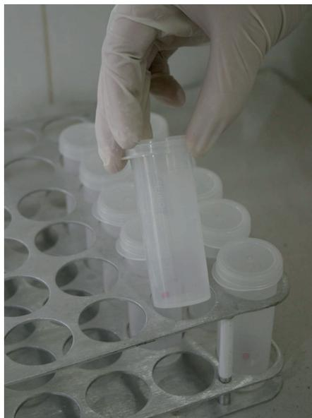
**Atenção:** O frasco de amostra deve ser manuseado com cuidado, evitando-se derrubar a tampa no chão ou o contato dela ou do interior do frasco com outros materiais ou possíveis contaminantes.
