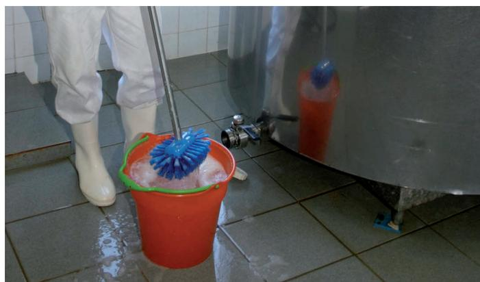
**d) Espalhe a solução de água morna com detergente alcalino no tanque**
