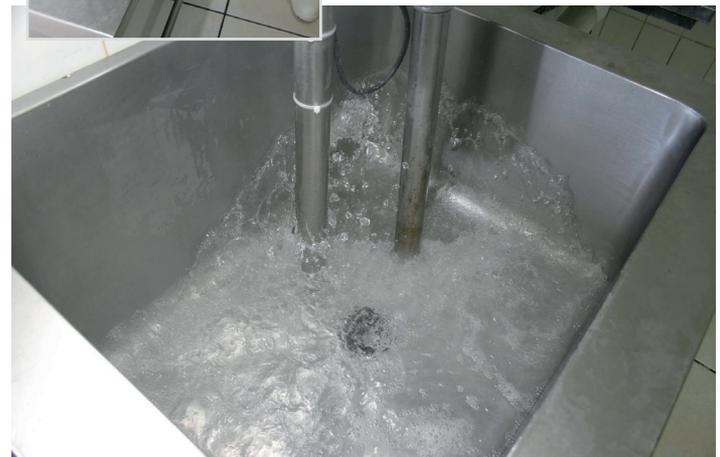
Detergente alcalino sendo colocado na água quente e homogeneizado na cuba, automaticamente
