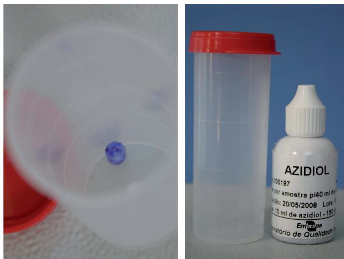
O azidiol líquido pode ser fornecido pelo laboratório em frascos conta-gotas, e o responsável pela coleta deve colocar duas gotas em cada frasco, para 30 mL a 40 mL de leite. Além do cloranfenicol e da azida sódica, esse conservante contém o corante azul de bromofenol, que confere às amostras de leite uma coloração azul clara.
