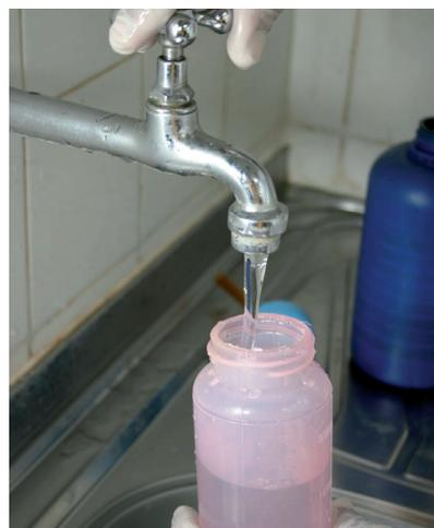
b) Coloque a água no frasco sem retorno
