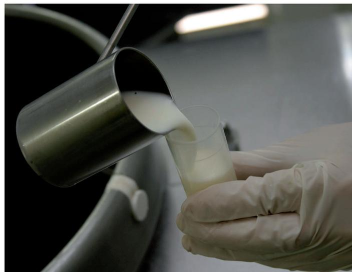
**Atenção: 1** – Não se deve ultrapassar 3/4 do frasco com leite (medida feita considerando-se o frasco tampado). Isso é feito para permitir a mistura do leite com o conservante no interior do frasco após a coleta.
