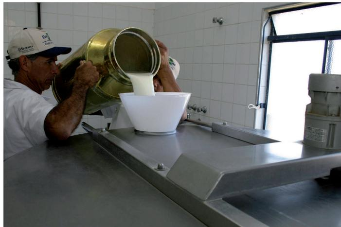
**Atenção:** Caso o tanque esteja numa altura que dificulte a visualização da boca da tampa, deve-se utilizar uma bancada para subir até uma altura adequada para ter acesso à boca da tampa superior do tanque de refrigeração e evitar acidentes.
