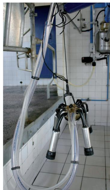
Recomenda-se que o diâmetro e o comprimento da mangueira longa do leite não dificultem o fluxo do copo coletor até a tubulação de transporte de leite. Dessa forma, o diâmetro de 5/8 de polegada é o preferido para evitar a restrição do fluxo de leite e o comprometimento do nível de vácuo na extremidade do teto. Além disso, o comprimento da mangueira longa de leite não deve ultrapassar 2,5 metros, dando-se preferência ao menor comprimento possível.
