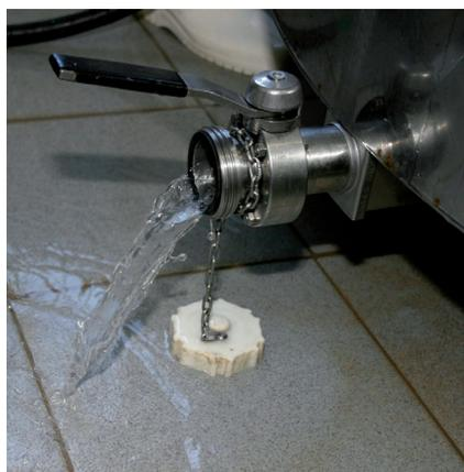
**b) Feche a válvula de saída de leite do tanque**
