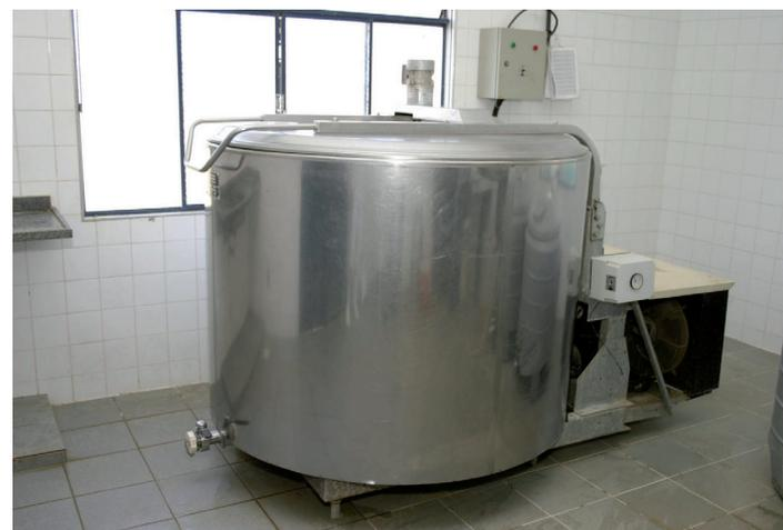
Quando se trata de tanque de refrigeração por imersão, o leite individual deve ser resfriado, conforme estabelece a IN nº 51, à temperatura de 7 °C, em no máximo três horas após o fim da ordenha.
