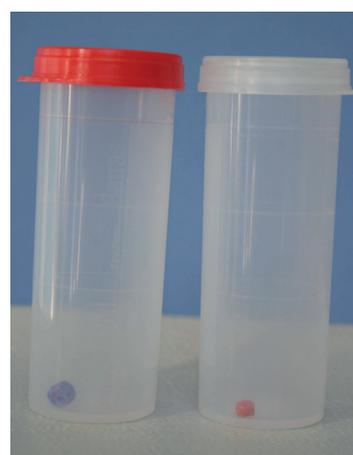
Os frascos utilizados para a coleta de amostras de leite destinadas à determinação da composição e à CCS possuem a tampa translúcida (mesma cor do frasco) e são disponibilizados com uma pastilha de conservante (Bronopol®) no seu interior.
