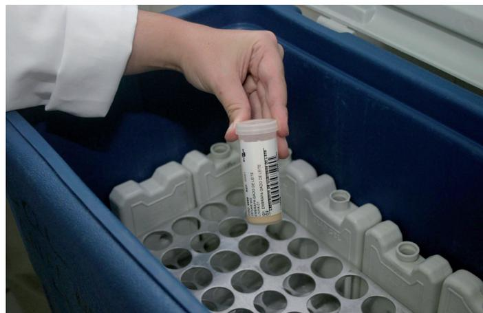
**Atenção: 1** – As amostras de leite devem ser mantidas sob refrigeração, em caixa isotérmica (tipo isopor ou outra) com gelo reciclável, desde imediatamente após a coleta até a entrega no laboratório. Deve-se garantir que a quantidade de gelo reciclável seja suficiente para manter a temperatura interna da caixa isotérmica em, no máximo, 7 °C.
