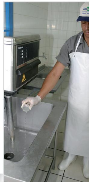
O detergente alcalino ajuda a retirar os resíduos de gordura e proteína do leite que permaneceram na tubulação depois da ordenha. A solução com detergente alcalino deve circular no equipamento de oito a dez minutos, em água quente (em torno de 70 °C). As recomendações do fabricante quanto ao tempo e à temperatura de uso devem ser seguidas rigorosamente.
