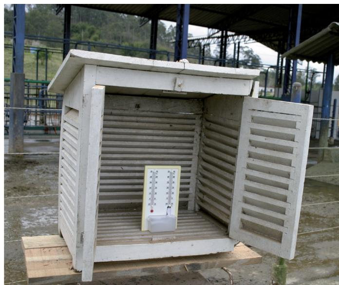
*Psicrômetro no interior do abrigo meteorológico*
