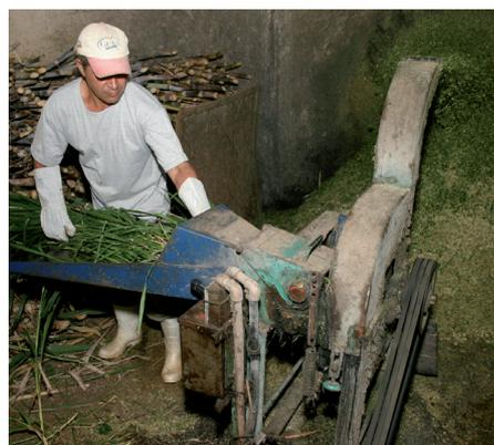
O uso de facas mal afiadas resultará em uma forragem toda desfibrada, o que, além de aumentar o desgaste da picadeira e o gasto com energia, reduzirá o consumo.
