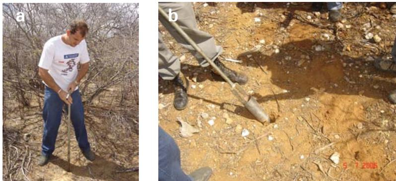
**Fig. 2.** Abertura do furo com o trado. (a) Uso do trato modelo caneco e (b) detalhes do trado
