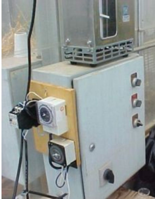
Figura 6. Temporizadores para iluminação e circulação de ar na solução nutritiva, e caixa de controle de ventilador e aquecedor.
