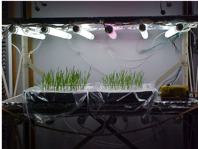
Fig. 4. Vista geral do teste, mostrando o sistema de iluminação e o compressor de ar à direita.
