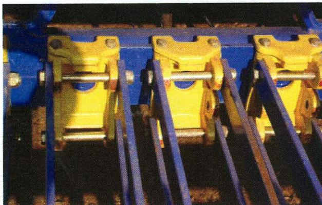
**Fig. 2.** Espaçamento com regulagem contínua entre linhas de semeadura.
