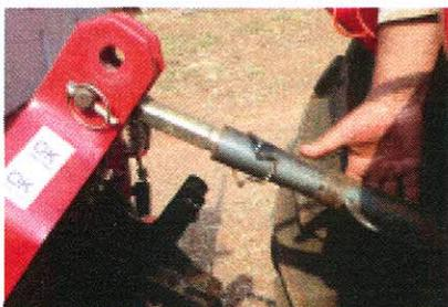
**Fig. 3.** Nivelamento da semeadora pelo ajuste no terceiro ponto do trator.
