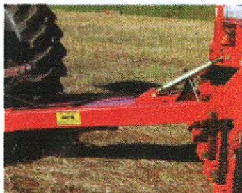
**Fig. 4.** Nivelamento da semeadora pelo ajuste no cabeçalho.
