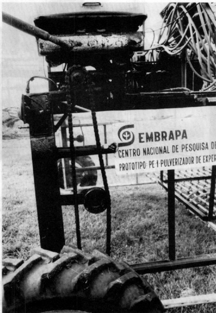
Figura 5. Tração por corrente com engrenagem superior e inferior e esticador da corrente.
