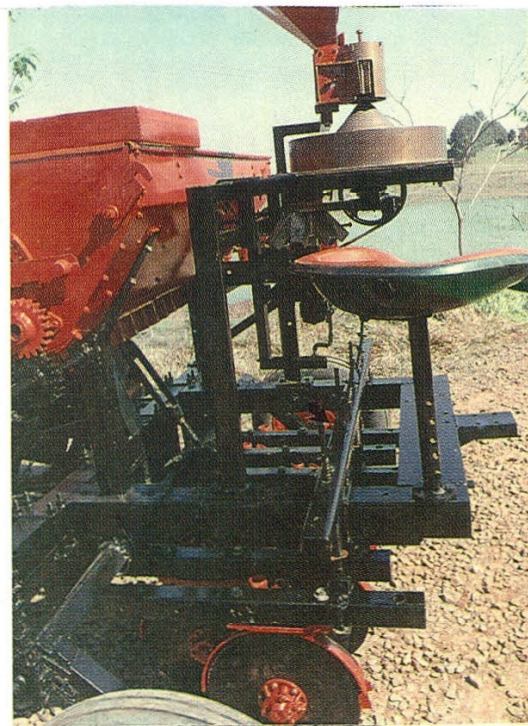
FIGURA 16. Detalhe do suporte das molas helicoidais.
