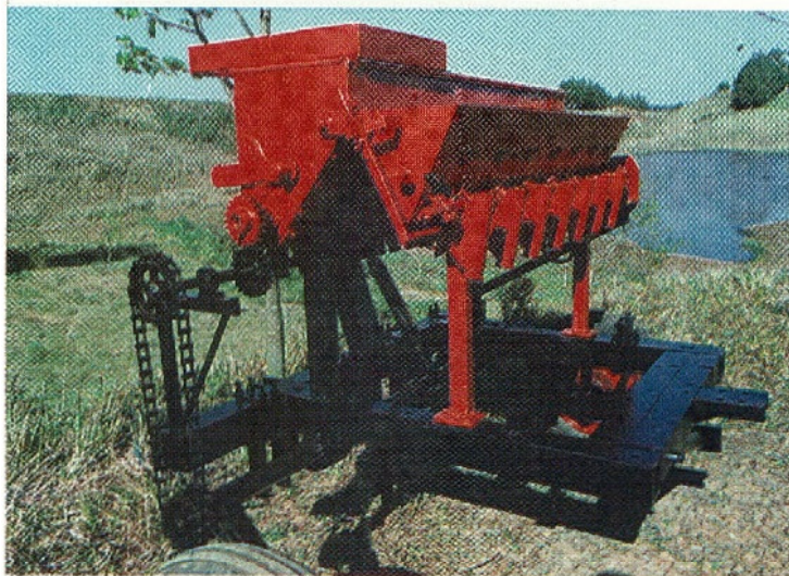
FIGURA 7a. Colocação da caixa de sementes, com distribuição por rotor dentado.
