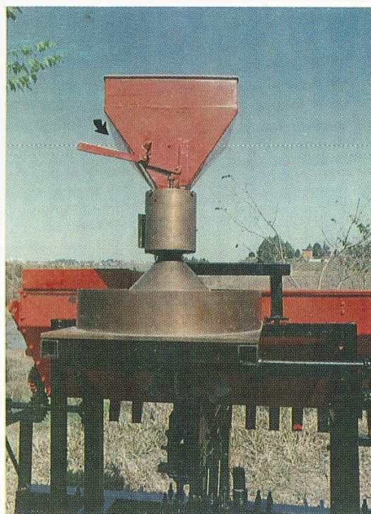
FIGURA 14. Distribuidor de fluxo contínuo adaptado ao prato Øyjord.
