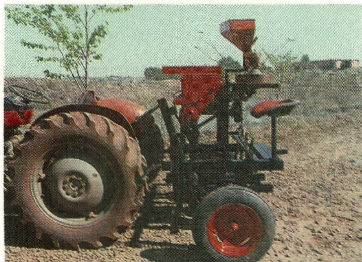
FIGURA 2. Semeadora experimental de parcelas acoplada ao trator MF 50—X.
