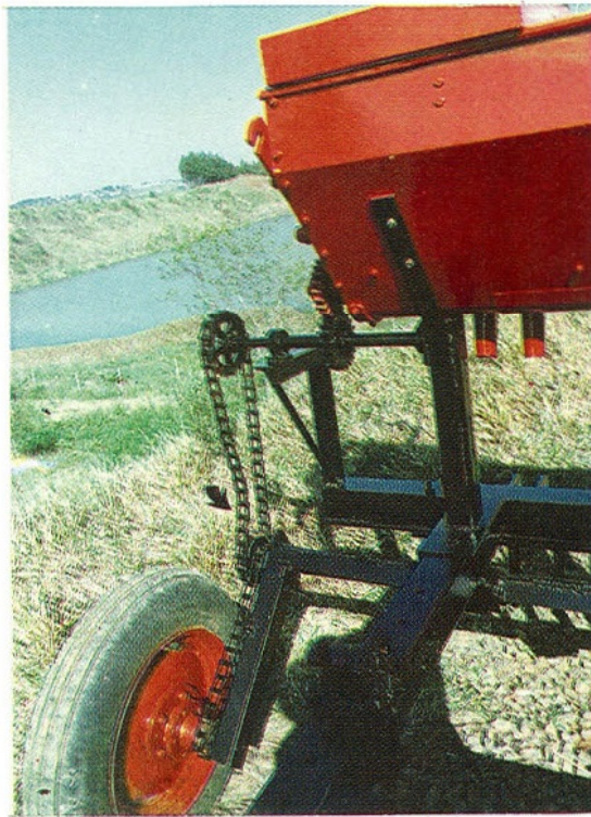
FIGURA 8. Sistema de transmissão de movimento com correntes e engrenagens.
