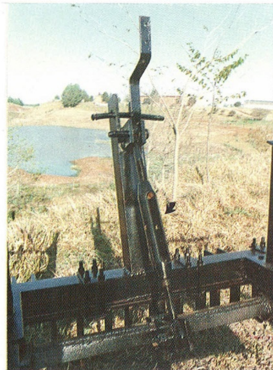
FIGURA 4. Estrutura do terceiro ponto, com detalhe de regulagem de profundidade.
