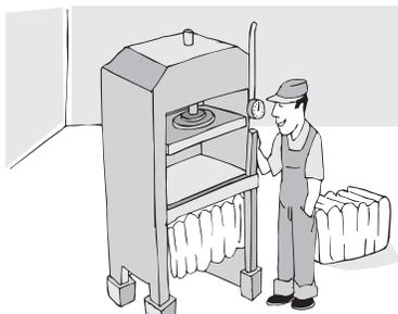
Na maioria das vezes, a confecção dos fardos é feita por prensas hidráulicas, do tipo pivotante, de dupla caixa, para permitir o uso contínuo da usina. A fibra é conduzida à caixa da prensa pelo empurrador e pelo calcador, em quantidades determinadas e a intervalos regulares, e comprimida para reduzir o volume
