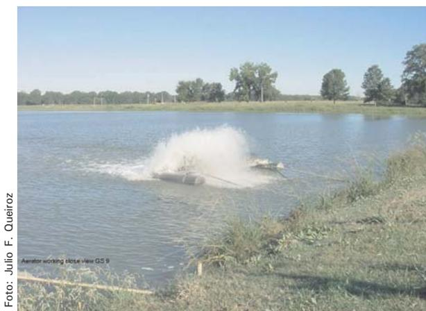
Fig. 4. Vista parcial de um viveiro de produção de catfish (bagre do canal) localizado em Greensboro, AL, EUA, e detalhe de um aerador em pleno funcionamento durante as primeiras horas do dia.
