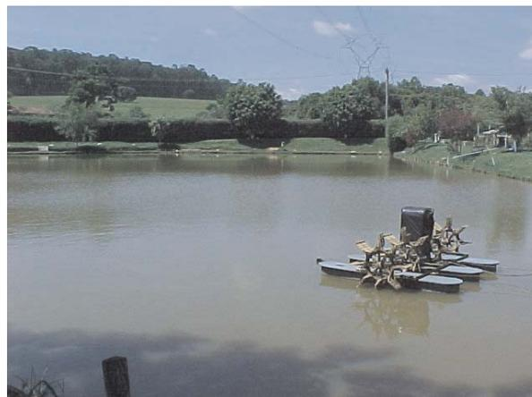
Fig. 5. Vista geral de um aerador de pás utilizado em lagos de pesca e viveiros de aqüicultura para aumentar a concentração de oxigênio dissolvido.
