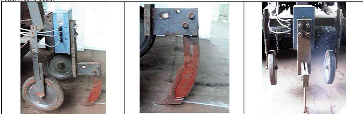
**Fig. 3.** Dinamômetro motomecanizado, constituído por conjunto “carro porta-ferramenta”, anel octogonal e haste sulcadora, destinado à avaliação de esforço de tração, no ensaio instalado em Latossolo Vermelho distrófico típico (LVd), em área localizada no município de Coxilha, RS.
