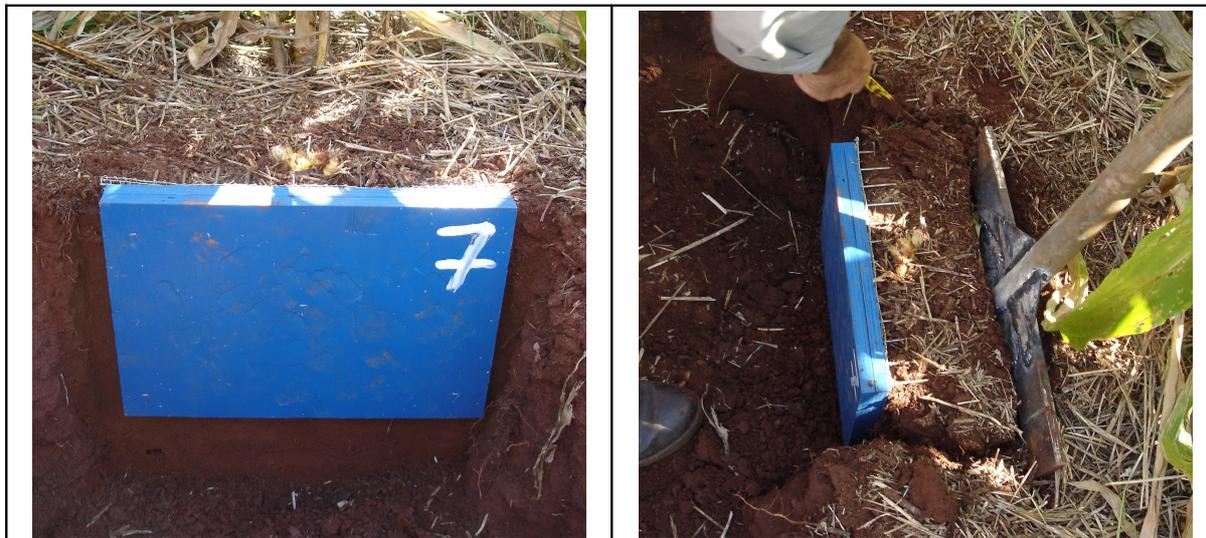
**Fig. 4.** Aspecto da coleta de monólito de solo, com “placas-de-pregos”, para avaliação da distribuição do sistema radicular da cultura de milho (*Zea mays*), no ensaio instalado em Latossolo Vermelho distrófico típico (LVd), em área localizada no município de Coxilha, RS.
