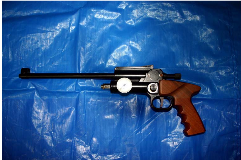
Figura 2. Pistola de CO 2 comprimido Distinject ® , modelo 35, utilizada para lançamento de dardos com anestésico.
