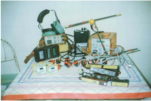
Fig. 4. Equipamentos de radiotelemetria, com receptores TR2 e TR4 e fones de ouvido usados durante as atividades de rastreamento dos jacarés.
