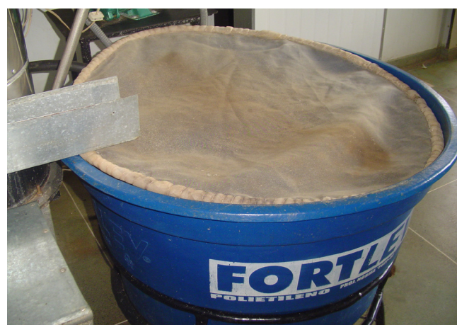
Fig. 6. Filtragem da água na saída da torneadora para remoção dos resíduos da abrasão.
