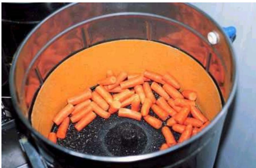
**Fig. 3.** Descascadora de batatas adaptada para o torneamento de segmentos de cenoura.
