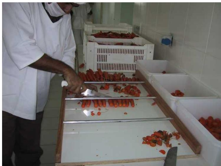
**Fig. 2.** Uso de gabarito para realizar os cortes de raízes de cenoura para o processamento
