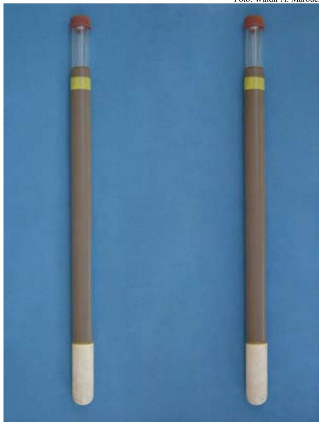
**Fig. 2.** Tensiômetros de punção para leitura com tensímetro.
