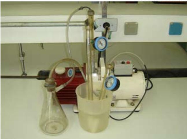
**Fig. 6** - Bomba de vácuo para saturação de tensiômetros.
