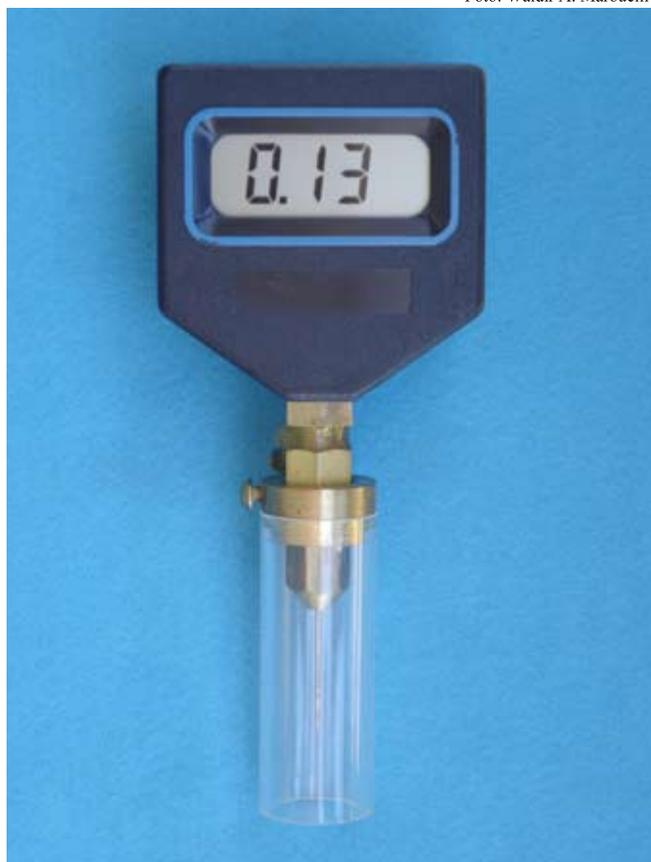
Figura 3. Tensímetro digital de punção.
