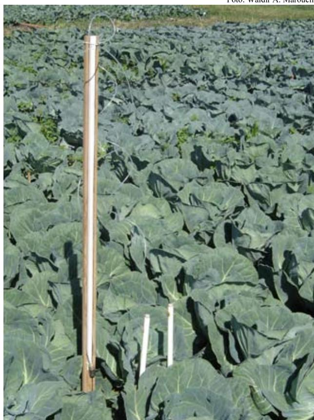
Figura 4. Tensiômetros com vacuômetro de mercúrio instalado em lavoura de repolho.
