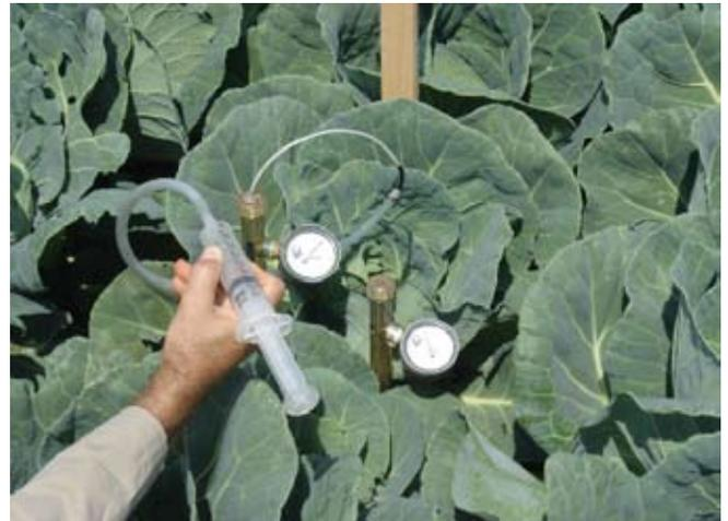
Fig. 12. Manutenção de tensiômetro no campo por meio de uma bomba de vácuo manual tipo seringa.
