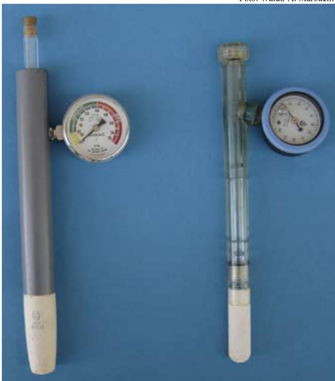
**Fig. 1.** Tensiômetros com vacuômetros metálico tipo Bourdon.
