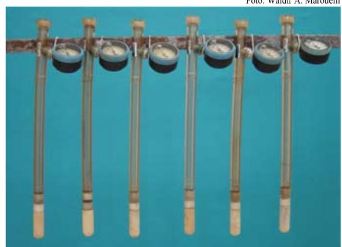
**Fig. 8** - Evaporação de água através da cápsula porosa visando verificar problemas de entrada de ar em tensiômetros.
