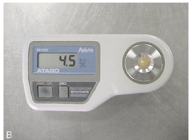
Fig. 2. Colocação da amostra no prisma do refratômetro (A) para leitura do teor de sólidos solúveis totais (B). Embrapa Hortaliças, Brasília-DF, 2003.
