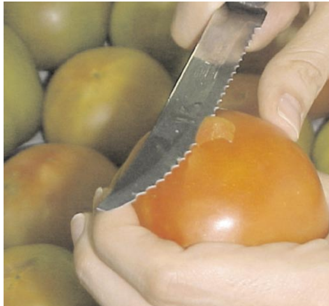
Fig. 6. Retirada de uma pequena porção da periderme do fruto para medição de firmeza. Embrapa Hortaliças, Brasília-DF, 2003.
