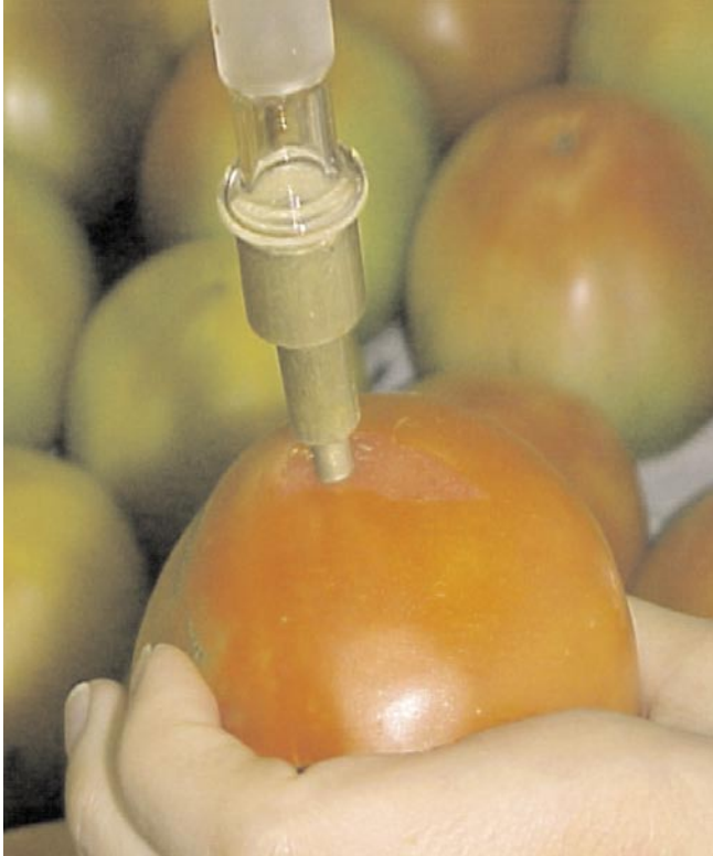
Fig. 7. Medição da firmeza de tomates com o emprego de um penetrômetro. Embrapa Hortaliças, Brasília-DF, 2003
