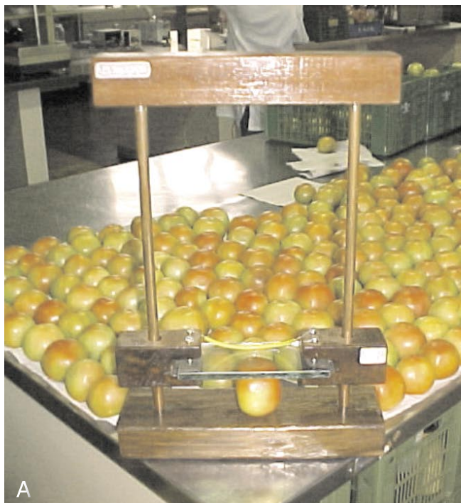
Fig. 9. Aplanador usado para medição de firmeza dependente do turgor celular (A) e fruto colocado na mesa de prova do equipamento (B). Embrapa Hortaliças, Brasília-DF, 2003.
