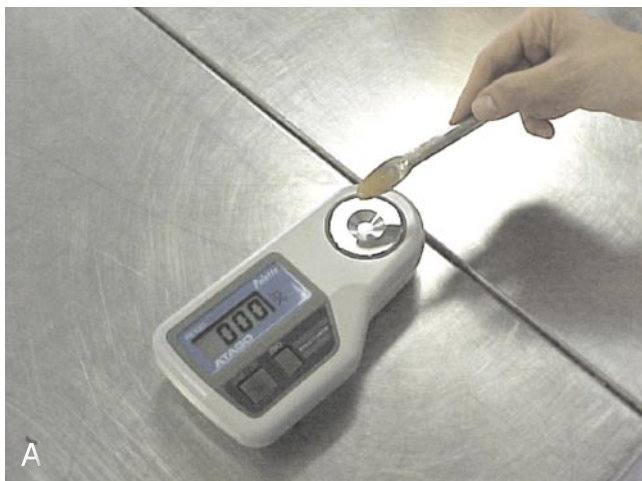
Fig. 2. Colocação da amostra no prisma do refratômetro (A) para leitura do teor de sólidos solúveis totais (B). Embrapa Hortaliças, Brasília-DF, 2003.
