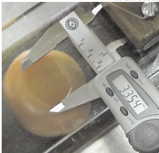
Fig. 10. Medição da figura elipsóide formada na placa de vidro do aplanador. Embrapa Hortaliças, Brasília-DF, 2003.
