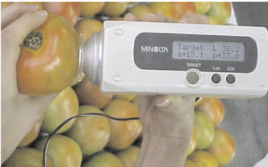
Fig. 11. Medição da cor (sistema L*a*b*) de tomates com um colorímetro portátil. Embrapa Hortaliças, Brasília-DF, 2003.
