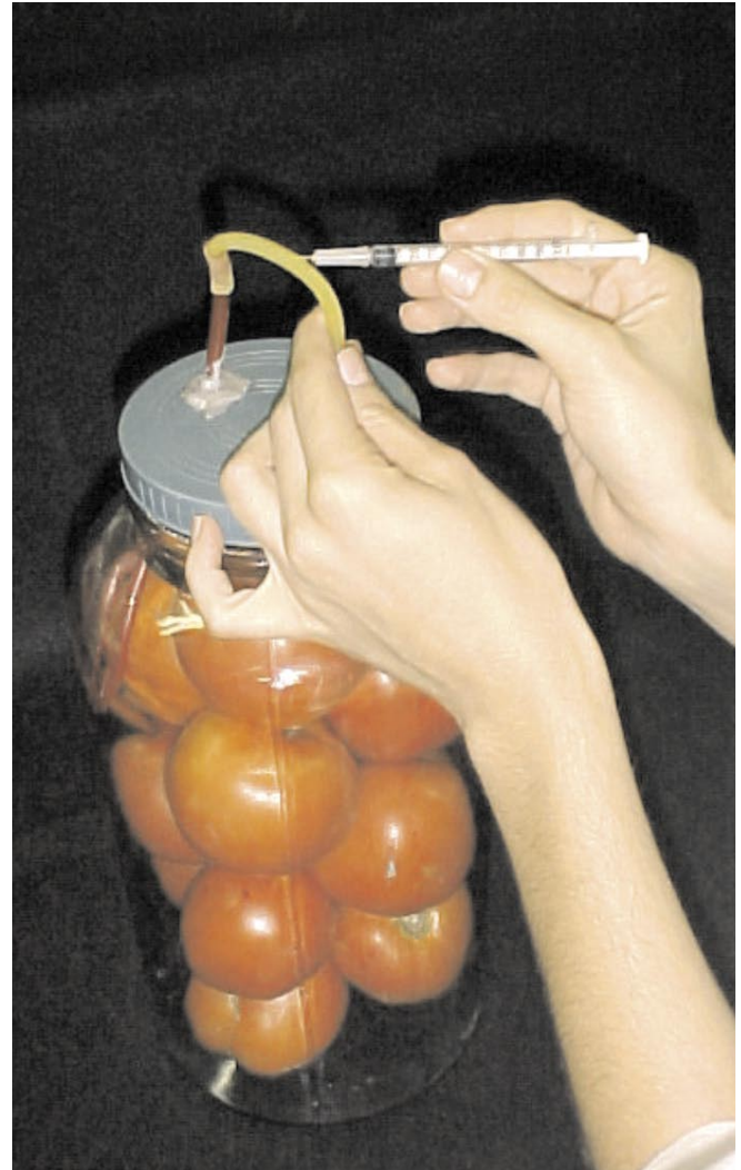
Fig. 4. retirada de amostra da atmosfera interna do jarro com o emprego de seringa hipodérmica de 1 mL. Embrapa Hortaliças, Brasília-DF, 2003.
