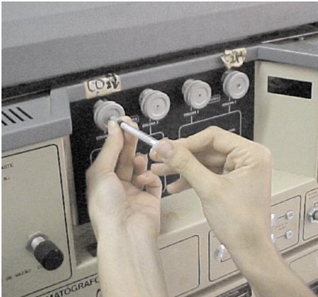
Fig. 5. Injeção da amostra retirada do jarro em cromatógrafo à gás. Embrapa Hortaliças, Brasília-DF, 2003.
