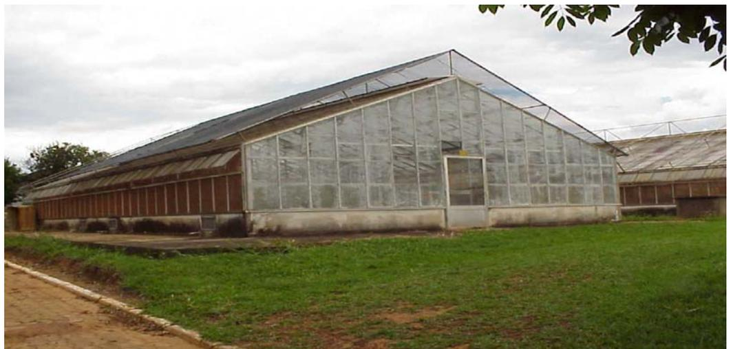
Fig. 27. Estufa modelo 'capela' com cobertura e cortinamento de vidro, semiclimatizada e com malha de proteção negra da Embrapa Hortaliças.
