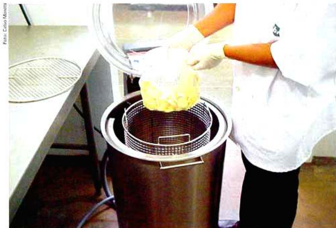
Fig. 5. Centrifugação (1-5 minutos) de raízes de mandioquinha-salsa em centrífuga de aço inoxidável. Embrapa Hortaliças, Brasília, DF.
