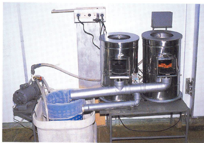
Fig. 7. Conjunto de equipamentos para processamento de cenoura: A-torneadoras, B-motobomba, C-caixa d'água e filtro.
