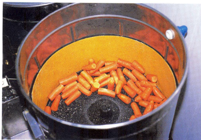
Fig. 6. Torneamento de pedaços de cenoura por meio de abrasão.
