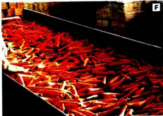
Figura 06 (A-F) – Lavador de esteira: descarregamento (A); primeira lavagem (B); segunda lavagem com utilização de escovas (C); secagem e aplicação de produtos químicos (D e E) e seleção de raízes (F).
