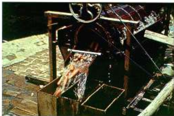
(7) Exemplo de lavadora usada para cenoura e outras raízes, onde é importante observar-se a qualidade da água e a sacagem após a lavagem, entre outros fatores.
