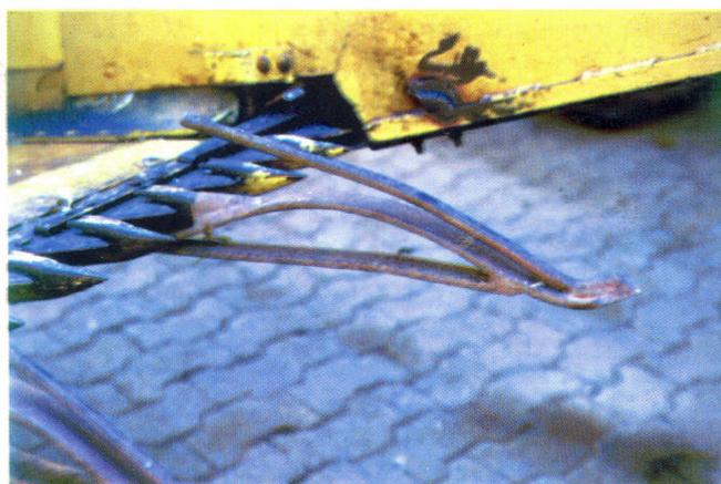
Figura 16: Garfo levantador em detalhe.
