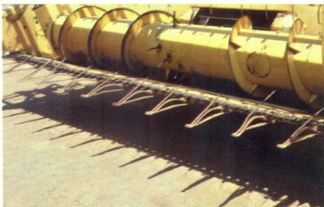
Figura 15: Plataforma frontal adaptada para a colheita de grão-de-bico.
