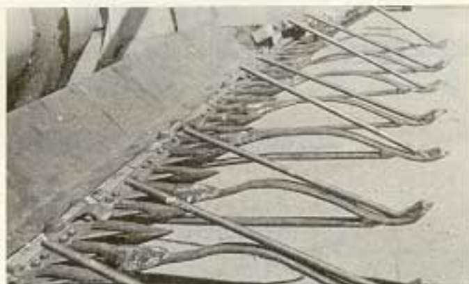
Garfos levantadores e barra retentora de solo na plataforma de corte da colheitadeira automotriz.
