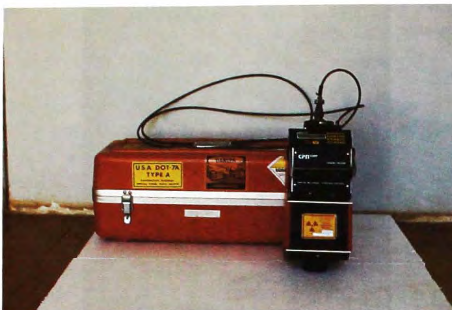
FIG. 7. Sonda de nêutrons utilizada para medir umidade do solo.
