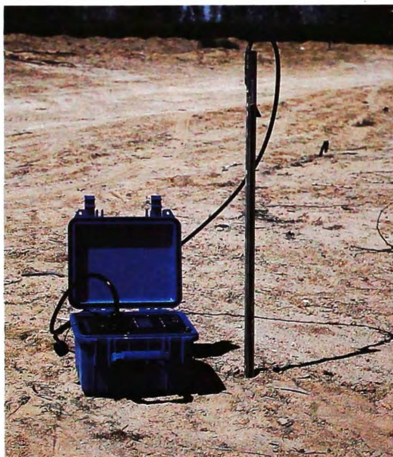
FIG. 8. TDR (Time Domain Reflectometry) utiliza ondas eletromagnéticas para estimar a umidade do solo.
