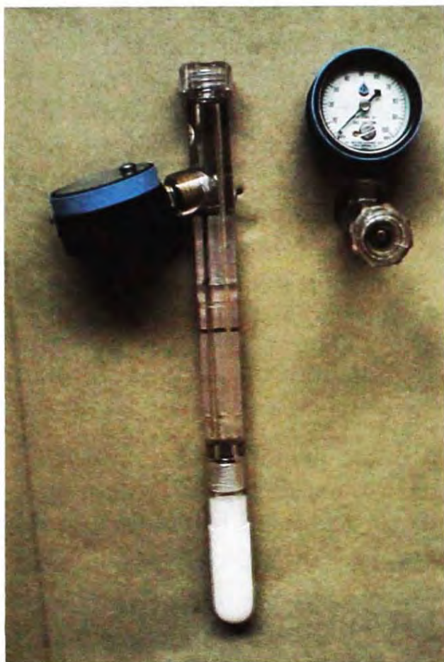
FIG. 4. Tensiômetro com manômetro metálico.
