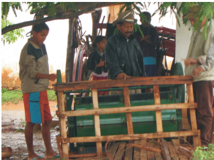
Fig. 18. Rolo-faca de uso coletivo para o preparo do solo.
