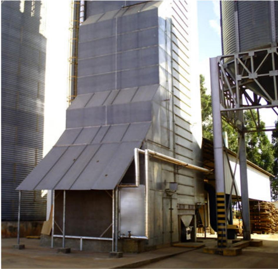
**Figura 4.** Caldeira acoplada ao secador para aquecimento do ar de secagem.
