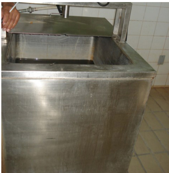
Fig. 2. Pasteurizador lento utilizado no tratamento térmico do leite de cabra.
