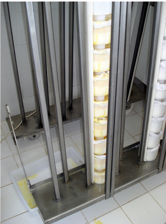
Fig. 11. Prensagem dos queijos utilizando prensa pneumática.
