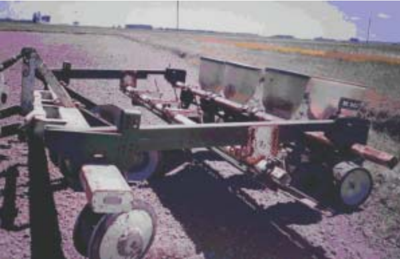
Figura 8. Camalhoieira/semeadora equipada com discos. Embrapa Clima Temperado, 2005.
