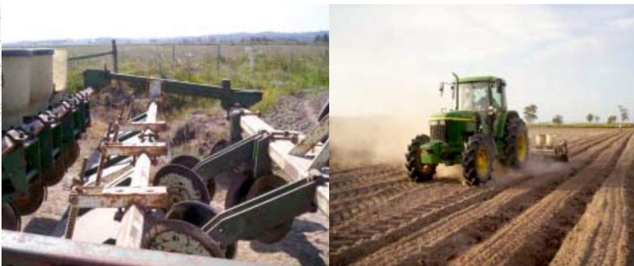
Figura 2. Camalhoeira/semeadora equipada com discos e operação de semeadura. Embrapa ClimaTemperado, 2007.
