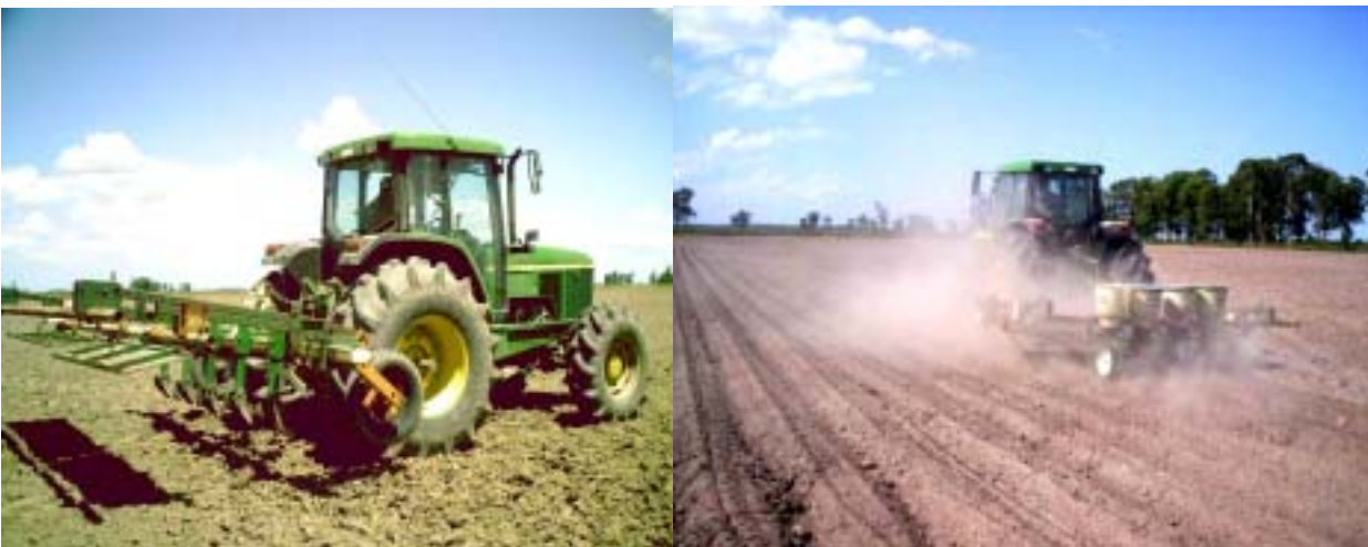
Figura 1. Camalhoerira/semeadora equipada com sulcadores e operação de semeadura. Embrapa Clima temperado, 2007.
