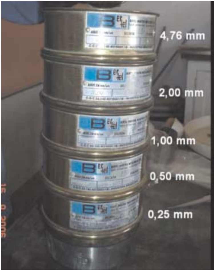
Figura 5. Peneiras com diferentes malhas de diâmetro (4,76; 2,00; 1,00; 0,50 e 0,25 mm) utilizadas na avaliação da estabilidade de agregados do solo estáveis por via úmida e por via seca.
