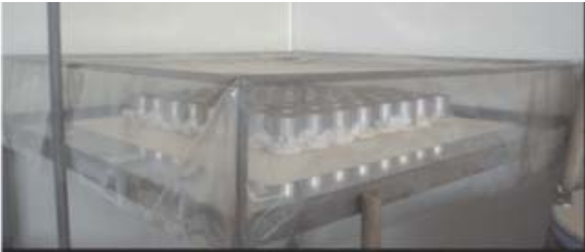
Figura 3. Amostras de solo em uma mesa de tensão para a avaliação da macroporosidade, da microporosidade e da porosidade total.
