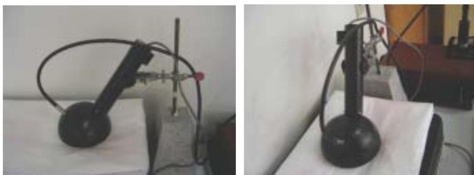
**Figura 2.** Disposição da semi-esfera, o sensor óptico e o canhão de luz.
