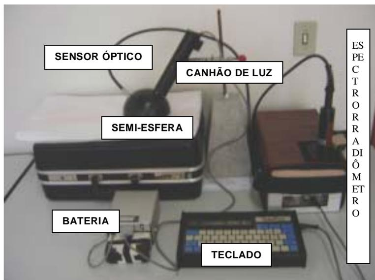
**Figura 1.** Componentes e acessórios do Espectrorradiômetro LI-1800.
