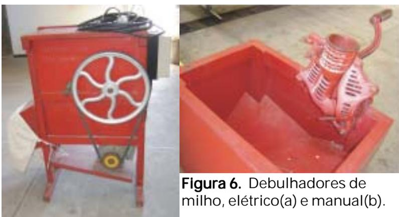
**Figura 6.** Debulhadores de milho, elétrico(a) e manual(b).
