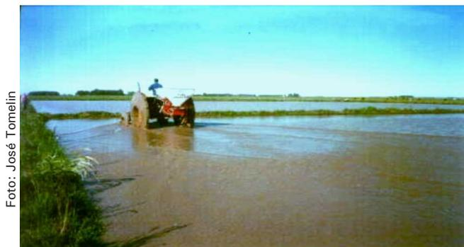
**Fig. 4.** Trator equipado com rodas tipo perfil "V" e semeadora à lança. Fonte: COOPRÉ. Arroio Grande, RS.
