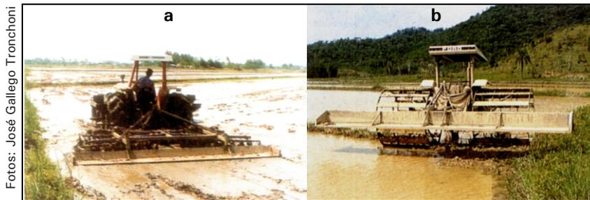
**Fig. 3.** Operação com pranchão alisador para acabamento da superfície do solo (a) e trator equipado com rodas-gaiola para acabamento do solo com pranchão alisador (b). Fonte: IRGA.
