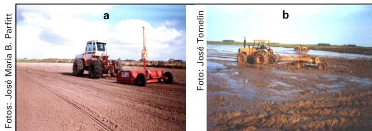
**Fig. 2.** Receptor de raios laser montado em plaina na execução da sistematização (a). Fonte: Gomes & Pauletto, 1999. Processo de nivelamento do solo com água, com lâmina traseira ou pranchão (b). Fonte: COOPRÉ. Arroio Grande, RS.
