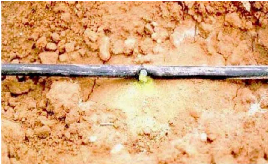
**Figura 13** – Gotejador obstruído por bactéria.
