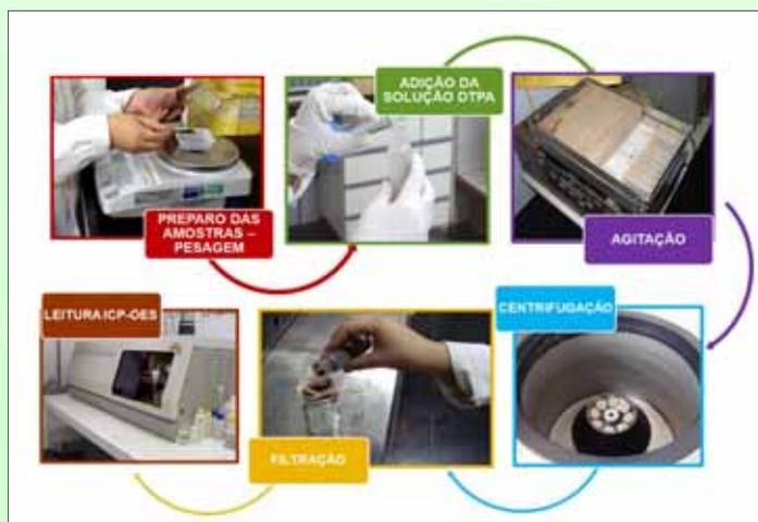
Figura 2. Representação esquemática do processo de extração pelo método DTPA.
